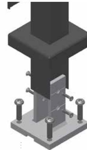
Ένωση βάσης κολώνας Column base connection
